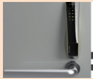
スマートロック 通信モジュールを活用し、遠隔地からの施錠・解錠が可能
